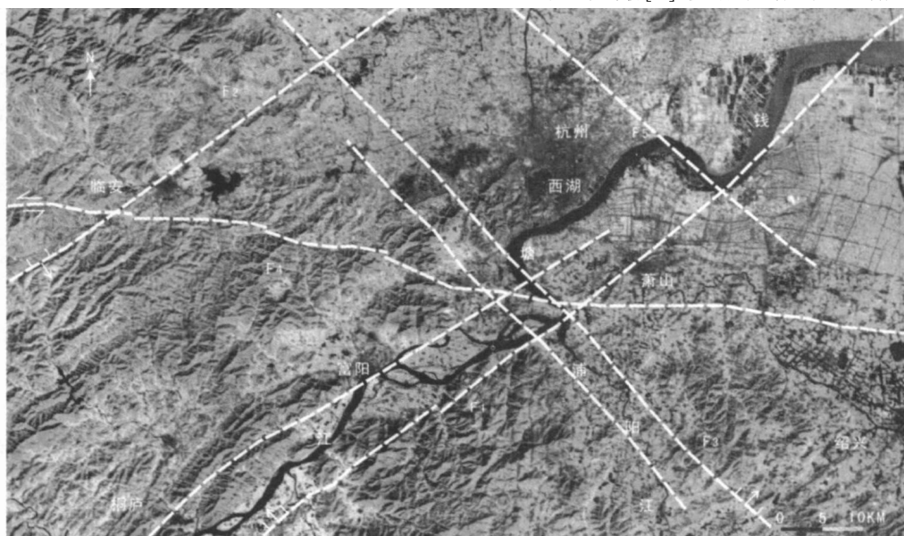
图 7 杭州及周边地区断裂构造解译图
