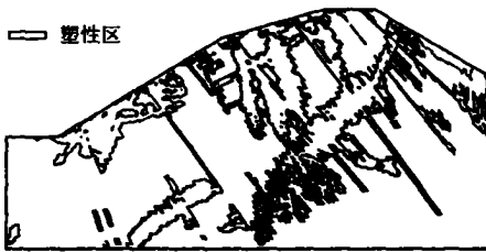
图 8 地震动下边坡塑性状态
