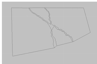
图 2 AutoCAD 提取特征曲线拟合的重构裂隙
