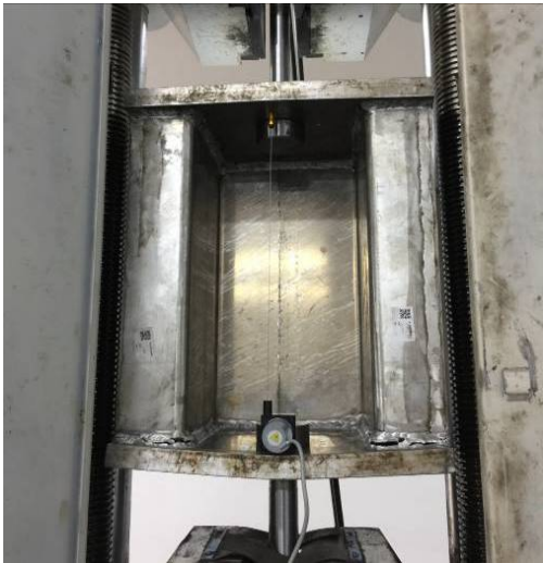
图 6 拉伸焊缝破坏 Fig.6 Tensile weld failure
