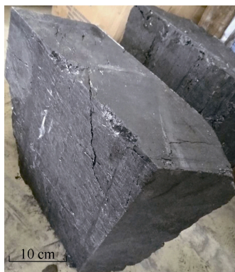
(a) 切割完成的大倾角煤样
