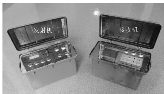
图 1 YDT175 型矿用本安型无线电波透视仪
