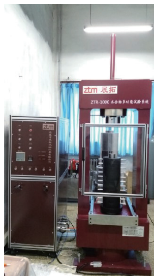
图 15 ZTR-1000 岩石力学参数测试设备
