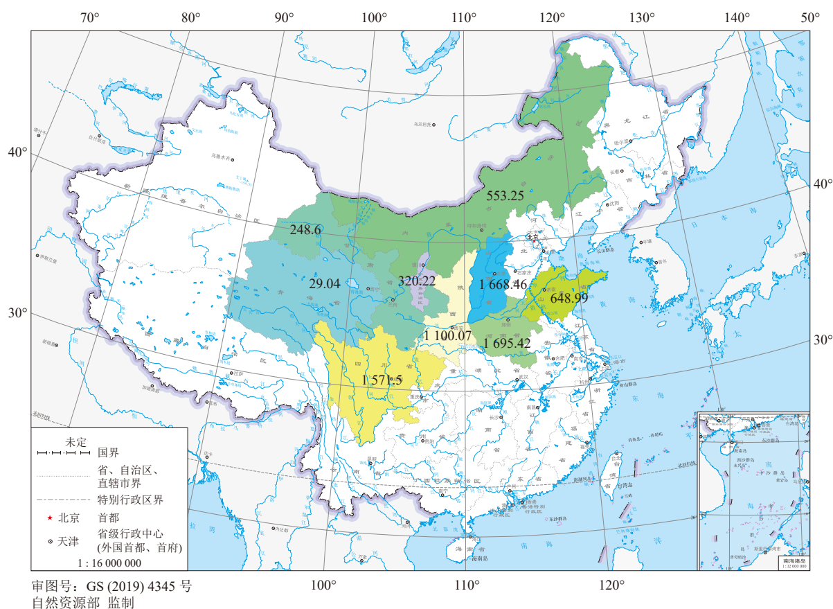
图 5 2016—2020 年黄河流域九省区关闭煤矿的井巷可利用地下空间分布(单位: 万 \text{m}^3 )
