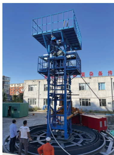
图 15 连续缆管储放设备运行实验
