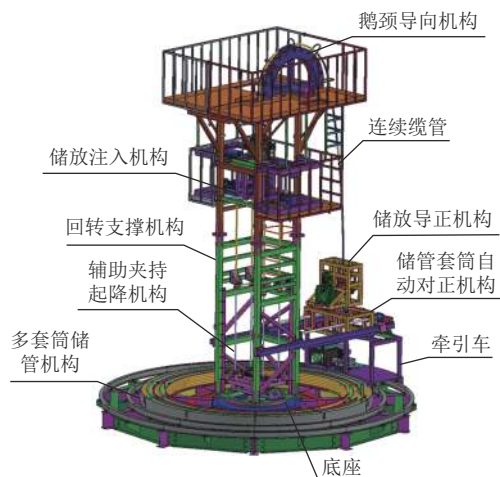
图 10 钻孔救援连续缆管储放设备整体结构
